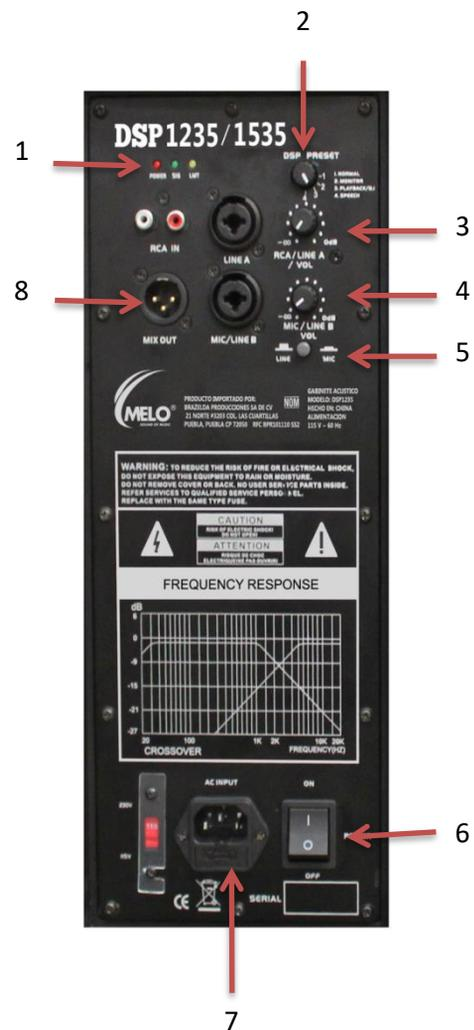
1. Leds indicadores de encendido, presencia de señal y clip.
